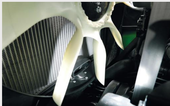
↑ Elektronisk viskostatisk blæser (eVisco) med sugeslange til luftfilterets forrensningssystem.
