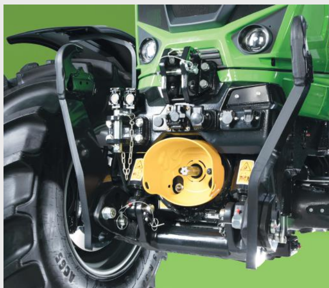
Frontlift med en løftekapacitet på 5.450 kg og DualSpeed frontmonteret kraftudtag.
