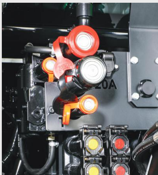
↑ Power Beyond med koblinger med flad side for en ren forbindelse.
