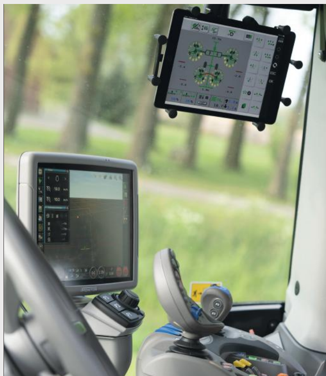
↑ Funktionen XTEND tillader visualisering af SDF Guidance eller lader dig kontrollere et ISOBUS redskab på en ekstern enhed, f.eks. en tablet.
