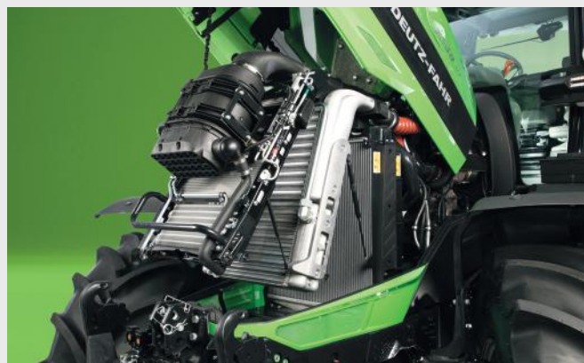
↑ Aluminiumskølesystem med enhåndsbetjent adgangsgivende håndtag og Powercore luftfilter.
