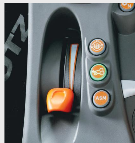
Uafhængigt gashåndtag og elektrohydraulisk aktivering af differentialespærre, firhjulstræk og automatisk ASM funktion.
