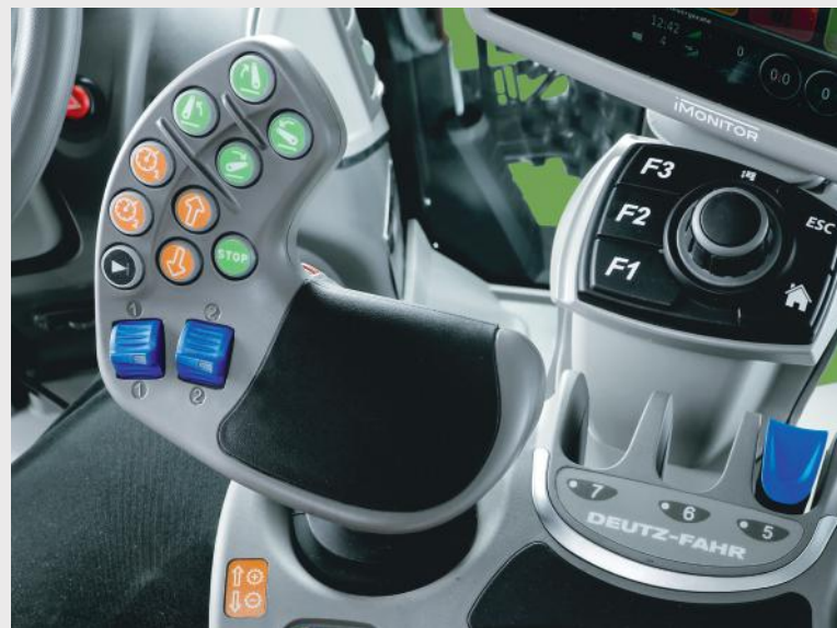
↑ Ergonomisk MaxCom joystick med front- og bag-lift, motor, transmission, forager og to proportionelle hydraulikventil-styreenheder.
