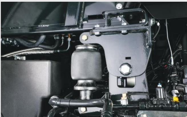
Luftaffjedret førerhus for en maksimal kørekomfort.
