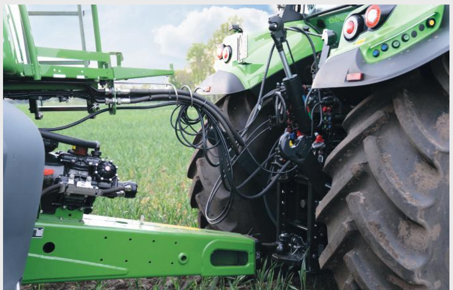
↑ Bagmonteret ophæng i transportposition for at reducere interferens med trækstænger i sving.
