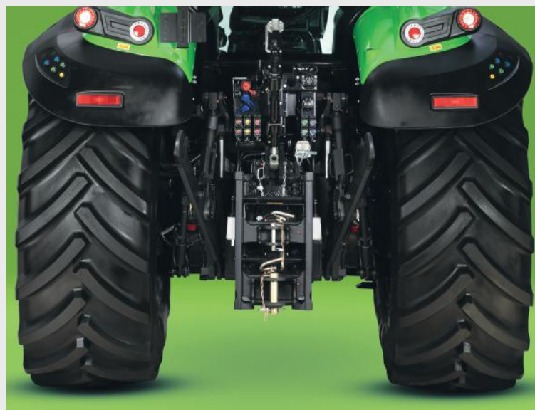
Bagmonteret ophæng, fem spoleventiler bagpå, udvendige betjeningsanordninger på skærmene i begge sider.
