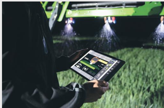
↑ UDVID funktionerne med tablet, kontrol over redskaber via ISOBUS UT også når du ikke er i førerhuset.
