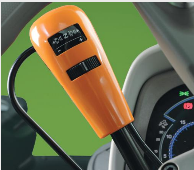
↑ PowerShuttle med Sense Clutch og fem retningskiftindstillinger.
