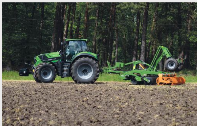
↑ Foragerstyring med Auto-Turn og ComfortTip PRO aflaster operatøren i de krævende situationer.
